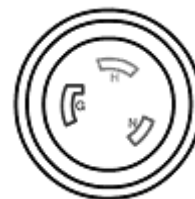
[N8142-35] NEMA L6-30P 用の コンセント形状 (AC200V) (工事必要)
