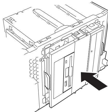
13. 取り付けたフロッピーディスクドライブにインターフェースケーブルと電源ケーブルを接続する。
