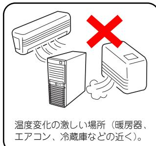
温度変化の激しい場所（暖房器、エアコン、冷蔵庫などの近く）。
