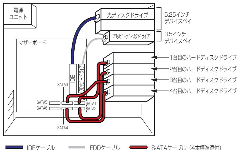
シリアルATAハードディスクドライブを2台以上接続している場合は、マザーボード上のコントローラを利用してRAIDシステムを構築することができます。構築できるRAIDレベルや構築方法の詳細については、「RAIDシステムのコンフィグレーション」(191ページ)を参照してください。
