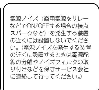
電源ノイズ（商用電源をリレーなどでON/OFFする場合の接点スパークなど）を発生する装置の近くには設置しないでください。（電源ノイズを発生する装置の近くに設置するときは電源配線の分離やノイズフィルタの取り付けなどを保守サービス会社に連絡して行ってください。）
