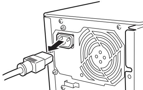
3. 本装置背面に接続しているケーブルをすべて取り外す。
