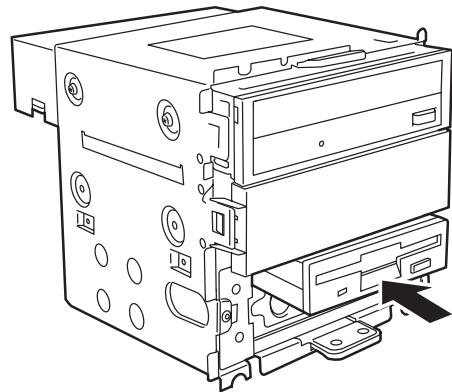
9. フロッピーディスクドライブをネジ（左2本、右1本）で固定する。
