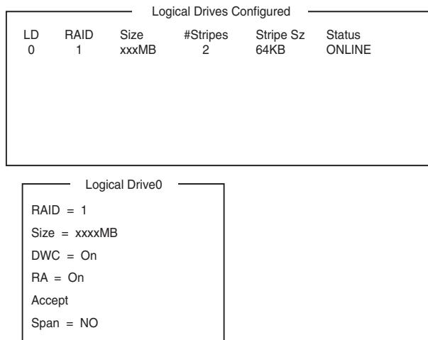
8. カーソルキーで「RAID」、「Size」、「DWC」、「RA」、「Span」を選択し、<Enter>キーで確定させ、各種を設定する。
