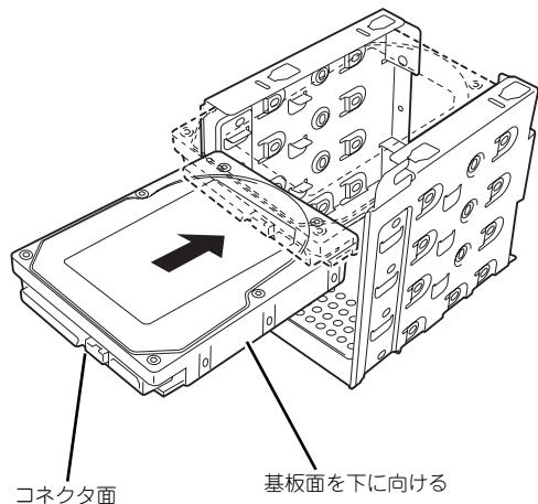
11. ハードディスクドライブとハードディスクドライブベイのネジ穴を合わせて、ハードディスクドライブに添付のネジ（4本）でハードディスクドライブを固定する。
