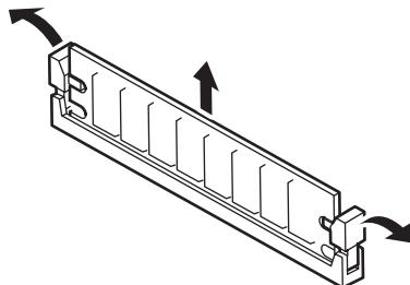
2. 取り外すDIMMのコネクタの両側にあるレバーを左右にひろげる。DIMMのロックが解除されます。
