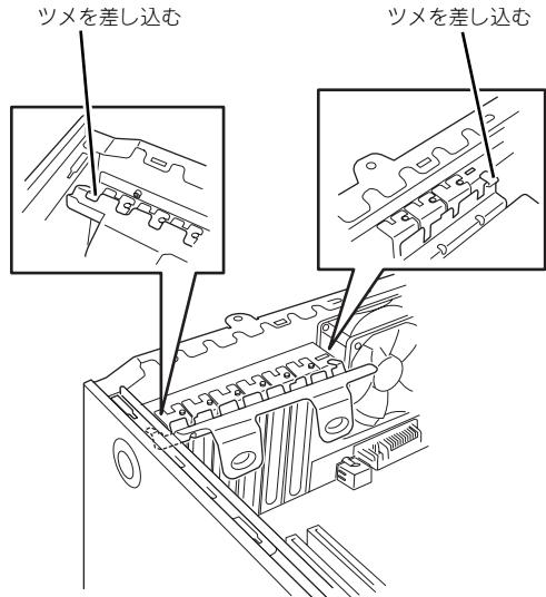
9. PCIボードリテンションスプリングのタブを1つずつ本装置背面に押し当てる。
