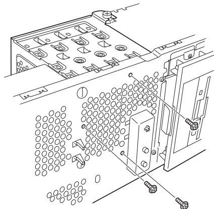
7. ハードディスクドライブベイを固定しているネジをゆるめる。
