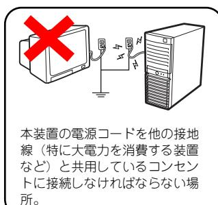
本装置の電源コードを他の接地線（特に大電力を消費する装置など）と共に用いているコンセントに接続しなければならない場所。
