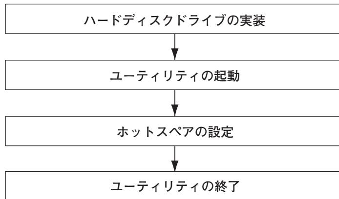
1. ホットスペア用のハードディスクドライブを実装し、本体装置を起動する。
