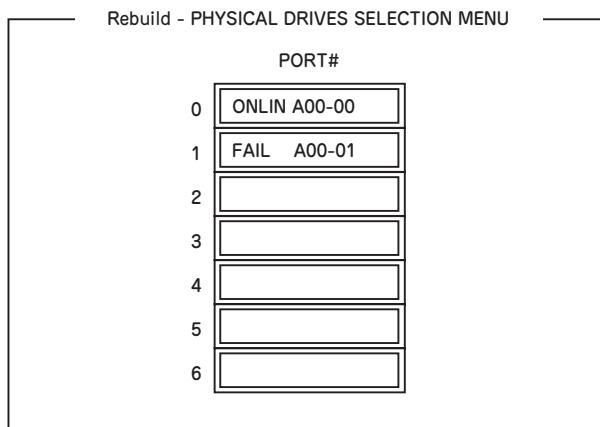
4. 「FAIL」になっているHDDにカーソルを合わせ、スペースキーで選択する。(複数のハードディスクドライブを選択可能(同時リビルド))
