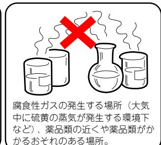
腐食性ガスの発生する場所（大気中に硫黄の蒸気が発生する環境下など）、薬品類の近くや薬品類がかかるおそれのある場所。
