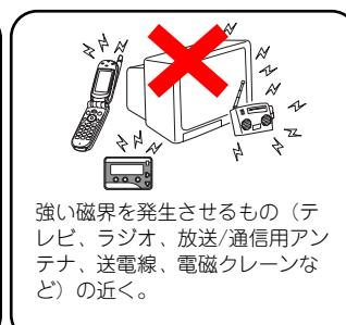
強い磁界を発生させるもの（テレビ、ラジオ、放送/通信用アンテナ、送電線、電磁クレーンなど）の近く。
