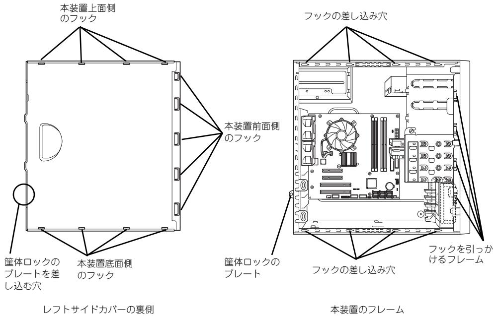
最後に取り外しの際に外したネジ（2本）でレフトサイドカバーを固定します。
