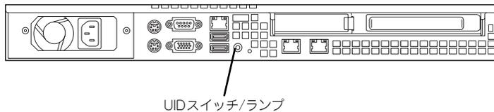
UID (ユニットID) スイッチを押すとUIDランプが点灯します。もう一度押すとランプは消灯します。
