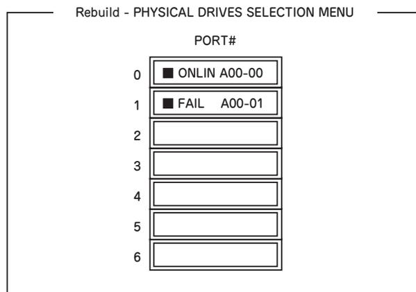
4. 「FAIL」になっているハードディスクドライブにカーソルを合わせ、<SPACE>キーで選択する。(複数のハードディスクドライブを選択可能(同時リビルド))
