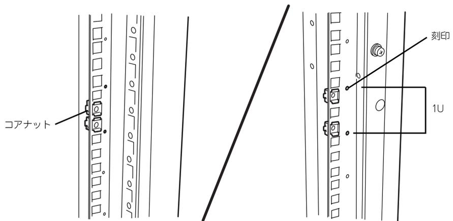
コアナットは下側のクリップをラックの四角穴に引っかけてからマイナスドライバーなどで上側のクリップを穴に差し込みます。
