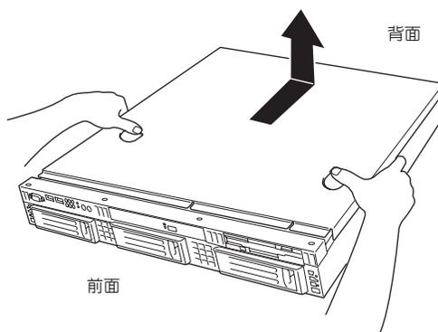
トップカバーを取り付けるときは、トップカバーにあるフックと本体のフレームにある穴をあわせていねいに本体に置いた後、前面へ向けてスライドさせてください。
