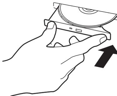
ディスクの取り出しは、ディスクをセットするときと同じようにトレイジェクトボタンを押してトレーを引き出します。
