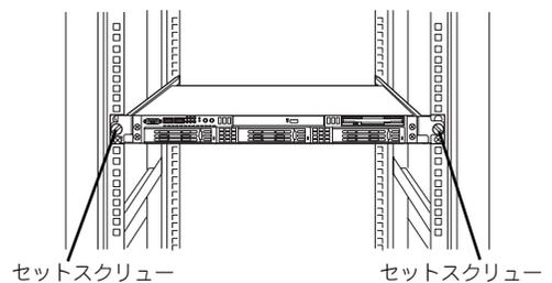
3. フロントベゼルを取り付ける場合は右図を参照して取り付ける。
