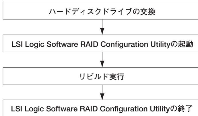
1. ハードディスクドライブを交換し、装置を起動する。
