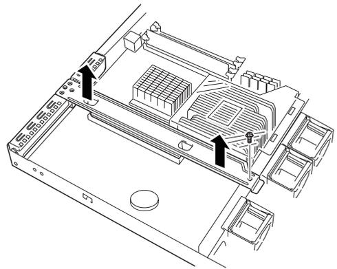
3. ライザーカードからネジ1本を外し、増設スロットカバーを取り外す。
