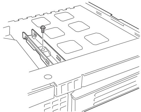
4. 内蔵USBフロッピーディスクドライブを取り付ける。
