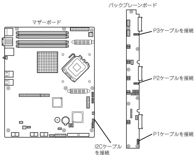
P1、P2、P3ケーブル、I2Cケーブルをボードのコネクタに接続します。
