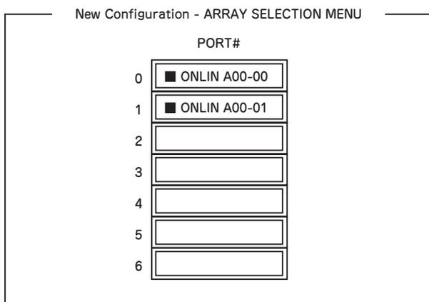
5. <F10>キーを押して、Select Configurable Array(s)を設定する。
