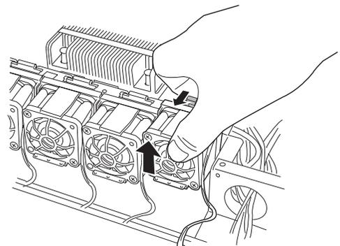
5. オプションファン上部のプラスチック部分を軽く内側に押しなががつまみ、オプションファンの下部の突起部分を溝に合わせ、軽く押しなが装着する。
