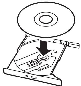
5. 図のように片方の手でトレーを持ちながら、もう一方の手でトレーの中心にある駆動部分にディスクの穴がはまるように指で押して、トレーにセットする。
