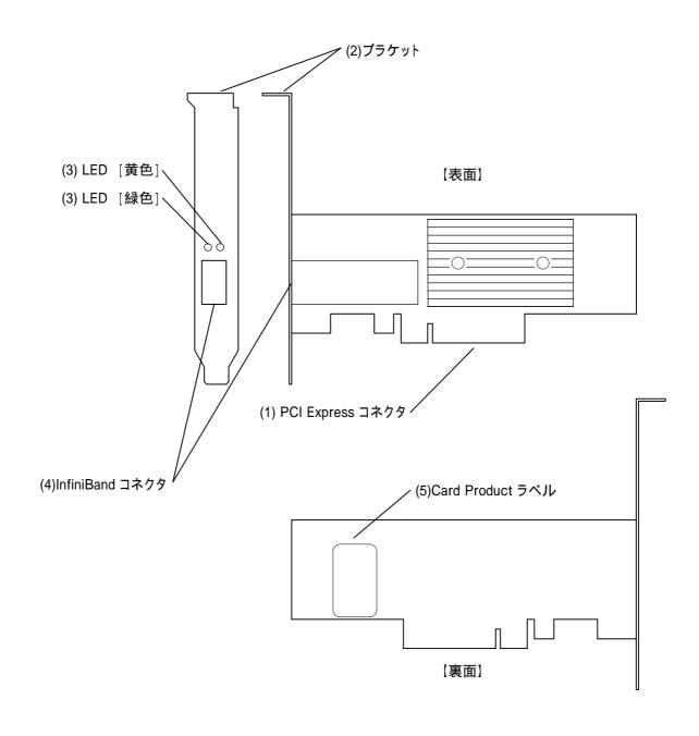
(1) PCI Express コネクタ 本体装置内部の PCI スロットと接続する端子。
