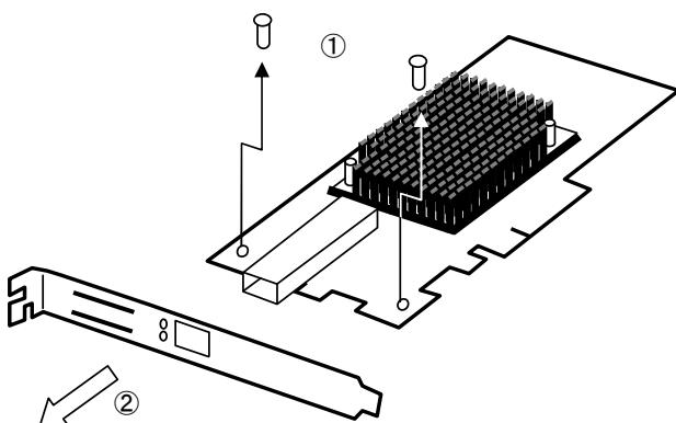
3. ロープロファイルブラケットを本製品に取り付け、ネジ(2本)で固定します。
