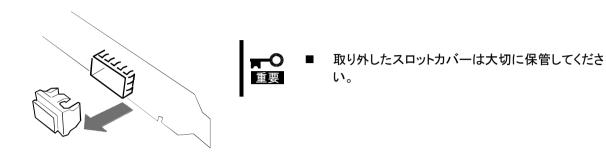
2. SFP スロットに SFP+モジュールを挿入する。
