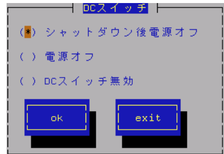
コントロールパネル(ESMpowersw)の[DC スイッチ]画面
